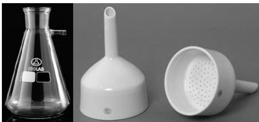
6.att. Laboratorijas filtrēšanas iekārtas sastāvdaļas: Bunzena kolba (pa kreisi), Bīhnera piltuve (pa labi)
