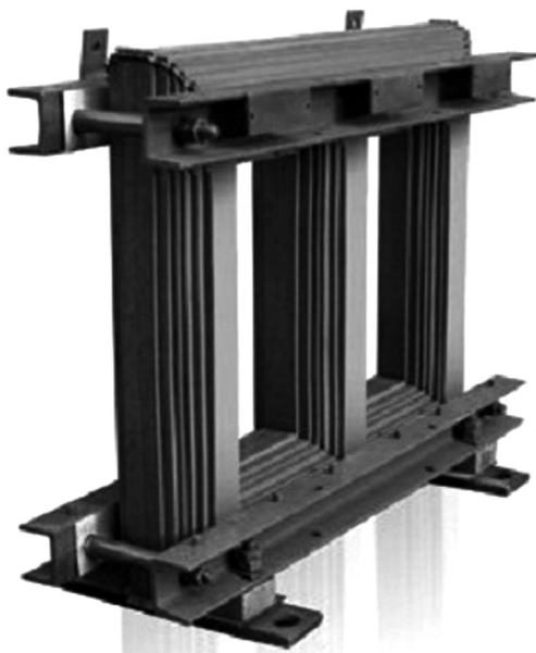
3.6. att. 10/5000 kVA trīsfāžu transformatora karkass.
